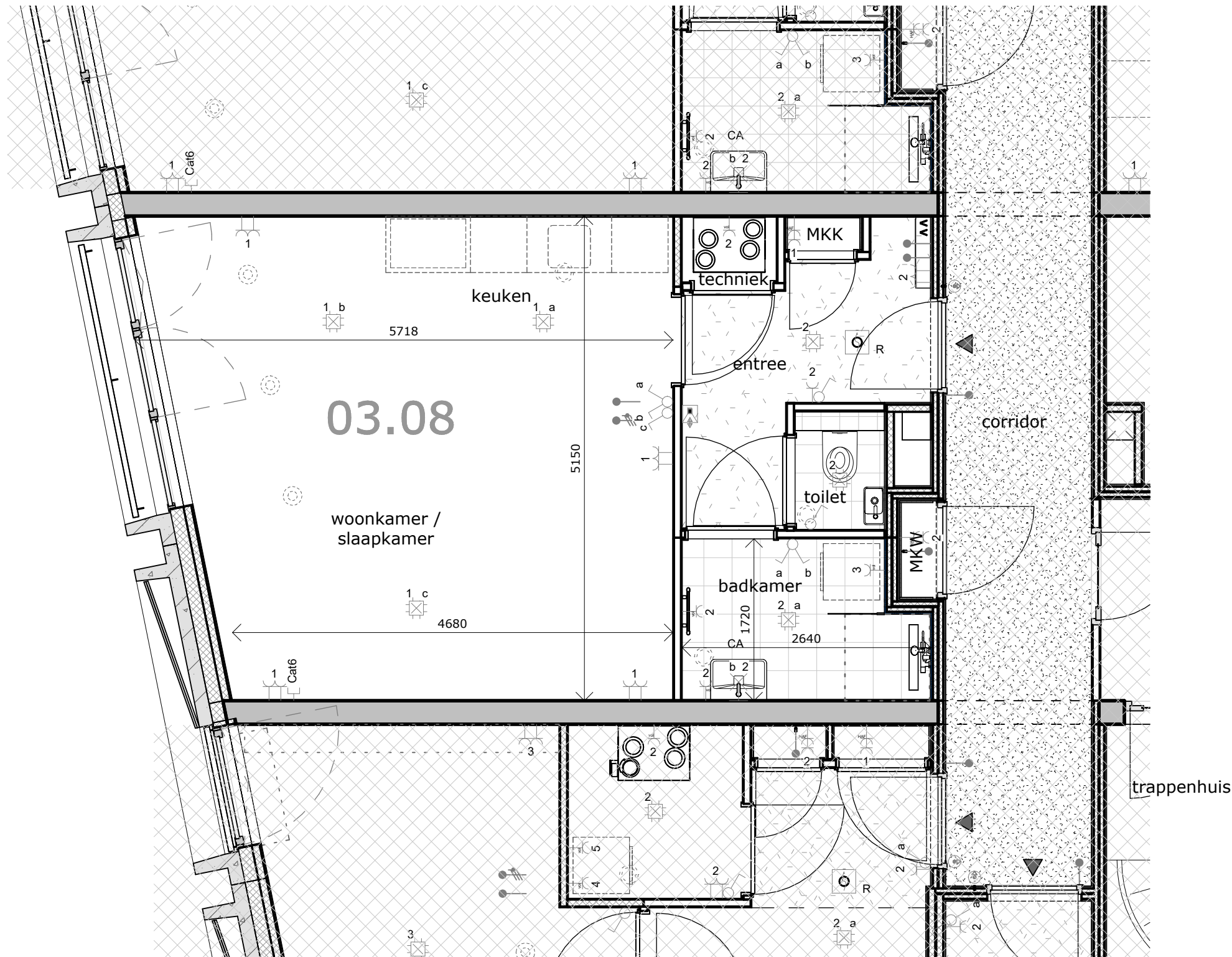
plattegrond bouwnummer 03.08 (derde verdieping)
